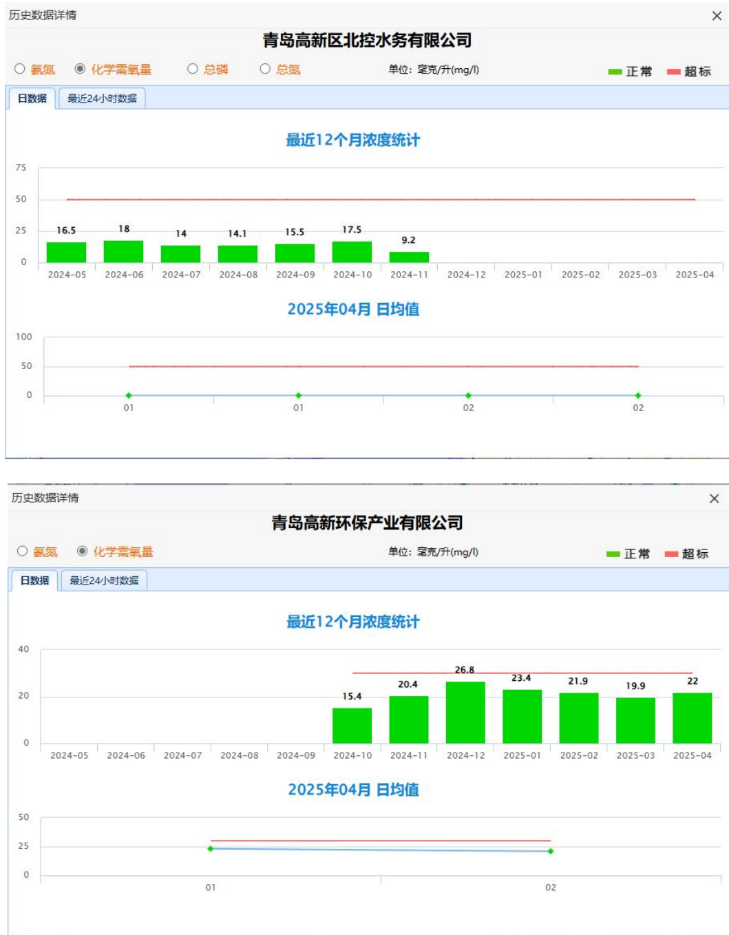
图 6.2-1 高新区污水处理厂在线监测数据
